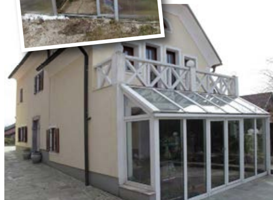
Zimski vrt je priljubljen element za pasivno izrabo sonca. Lahko je podaljšek stavbe (levo) ali pa je integriran v stavbo (desno). V obeh primerih je treba zagotoviti kakovostna senčila, ki preprečijo poletno pregrevanje.
