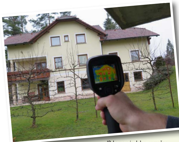
IR-kamera je dobro pomožno orodje pri analizi stanja za energetski pregled
