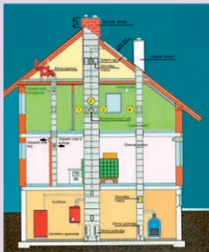
Glavni sestavni deli sodobnega masivnega dimnika.
