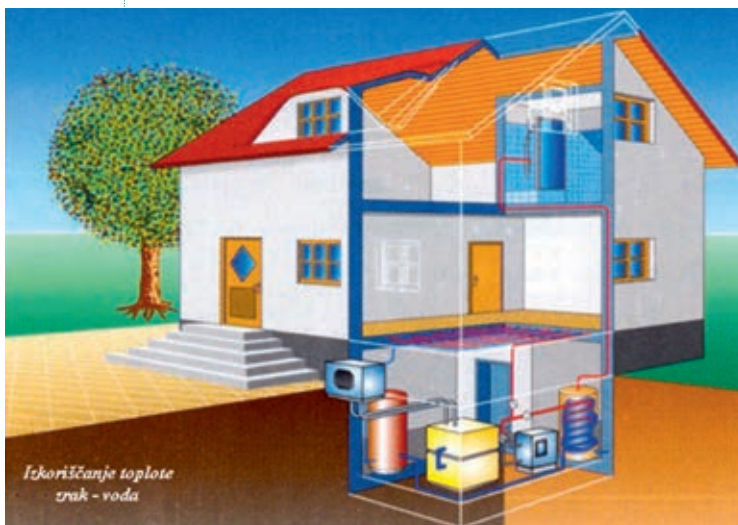
Schema inštalacije TČ zrak-voda. Vir: http://spletnik.si/matjaz/toplotne_rpalke.html
