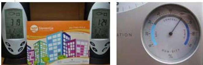
Za spremljanje vlage v stanovanju uporabljamo različne merilnike vlage (higrometer).
