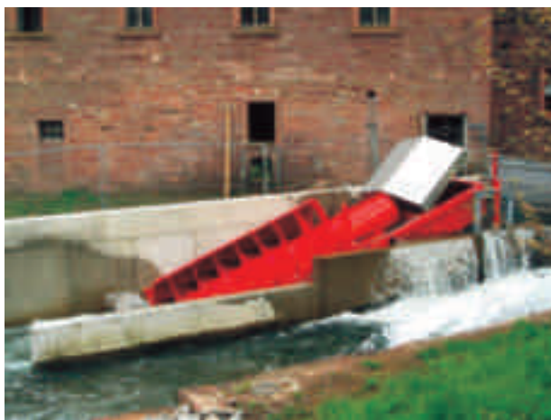
Slika 7 Kompaktna izvedba (CS & CU type) ne potrebuje dodatne gradnje, le ležišče turbine. Ves električni del je v zatesnjenem delu na vrhu vijaka, zato lahko prenese tudi poplave. Po zaključeni »papirologiji« se pripravi ležišče, v katerega se montira kompaktna izvedba elektrarne. Sistem omogoča prehod ribam dolvodno brez poškodb, skozi vijak gre brez težav tudi vejevje. Hrup, ki ga povzroča vrtenje polža ni velik, saj se polž vrti z enako hitrostjo, kot je tok vode, večji je hrup generatorja. Obstajajo tehnične rešitve, ki hrup izven objektov zmanjšajo na določene mejne vrednosti za hrup v življenjskem okolju
