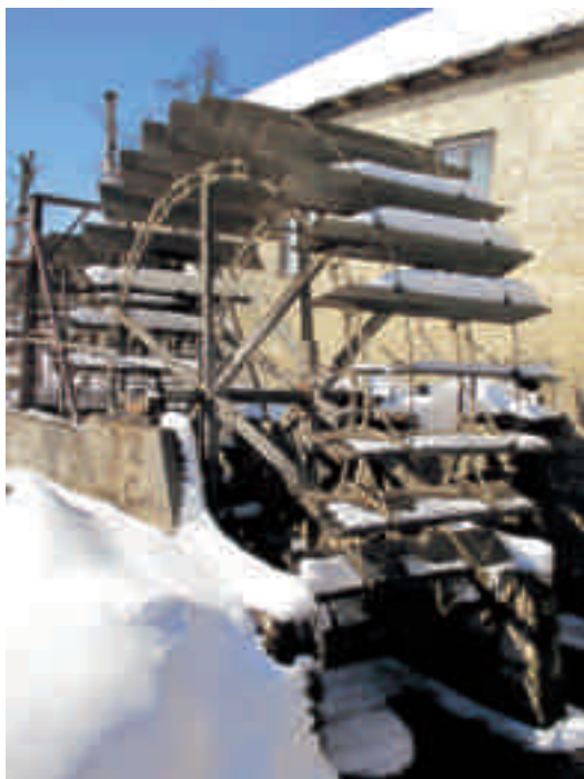
Slika 4 Na levi sliki je še delujoče vodno kolo, na desni spodaj pa sodobno oblikovano. Iz vodnega kolesa s premerom 5 m dobimo 4 kWh elektrike pri pretoku 100 l/s. Izkoristek na osi znaša 80 %, izgube reductorja 3 do 5 %, v generatorju 19 %, s čimer dobimo 60 %. Končni izkoristek od vode do elektrike v žici. Takšno kolo je veliko cenejše in lahko celo bolj učinkovito od majhne vodne turbine, zlasti na vodah z majhnim padcem
