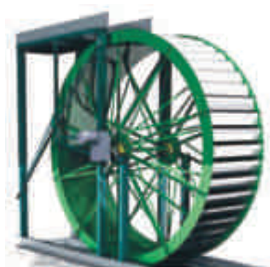
Slika 4 Na levi sliki je še delujoče vodno kolo, na desni spodaj pa sodobno oblikovano. Iz vodnega kolesa s premerom 5 m dobimo 4 kWh elektrike pri pretoku 100 l/s. Izkoristek na osi znaša 80 %, izgube reductorja 3 do 5 %, v generatorju 19 %, s čimer dobimo 60 %. Končni izkoristek od vode do elektrike v žici. Takšno kolo je veliko cenejše in lahko celo bolj učinkovito od majhne vodne turbine, zlasti na vodah z majhnim padcem
