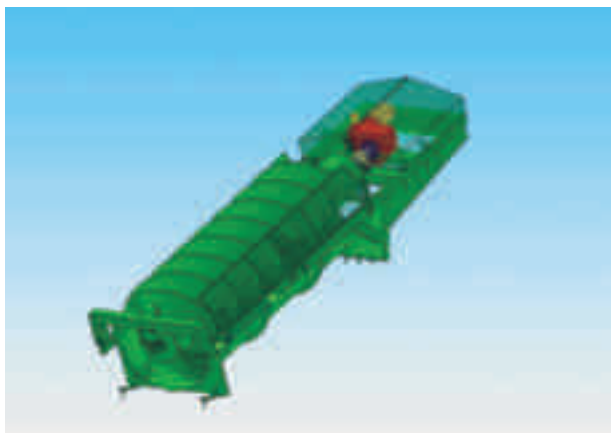
Slika 7 Kompaktna izvedba (CS & CU type) ne potrebuje dodatne gradnje, le ležišče turbine. Ves električni del je v zatesnjenem delu na vrhu vijaka, zato lahko prenese tudi poplave. Po zaključeni »papirologiji« se pripravi ležišče, v katerega se montira kompaktna izvedba elektrarne. Sistem omogoča prehod ribam dolvodno brez poškodb, skozi vijak gre brez težav tudi vejevje. Hrup, ki ga povzroča vrtenje polža ni velik, saj se polž vrti z enako hitrostjo, kot je tok vode, večji je hrup generatorja. Obstajajo tehnične rešitve, ki hrup izven objektov zmanjšajo na določene mejne vrednosti za hrup v življenjskem okolju
