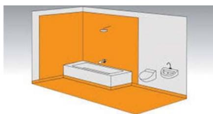
Vse vogalne stike je potrebno dodatno zatesniti s tesnilnimi trakovi, prav tako je potrebno dodatno zatesniti mesta prebojev – okrog sifonov, odtokov, armatur, ventilov ipd. Reže med cevmi in ploščami je potrebno zatesniti s silikonskim ali akrilnim kitom. Priporočljiva je uporaba tesnilnega premaza po celi površini mokre cone. Tudi keramično
